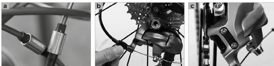
Od zadaj poglejte zadnji zobnik in preverite, ali se zgornji vodilni valj menjalnika nahaja natanko pod konicami zob zobnika. Položaj po potrebi popravite s končnim naslonskim vijakom (**d**). Pri menjalnikih so vijaki pogosto označeni s »H« za »high gear« in »L« za »low gear«. »High gear« v tem primeru pomeni težko stopnjo prestav, torej mali zobnik.
