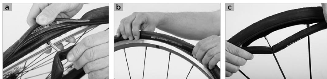
Bodite pozorni, da zračnica ni stisnjena med pnevmatiko in platiščem. Zračnico z roko vedno znova potisnite v notranjost pnevmatike (c).
